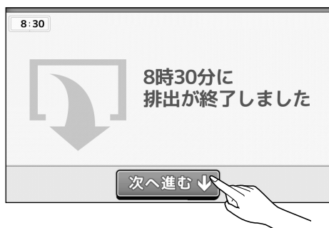
〔排出運転自動停止 画面〕
